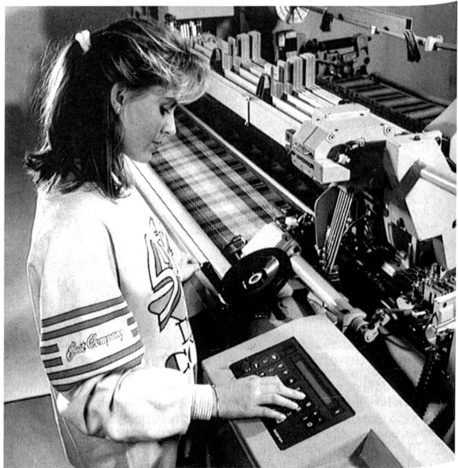
Sulzer-Rüti-Achtfarben-Greiferwebmaschine G 6100, ausgerüstet mit zentraler Mikroprozessorsteuerung
