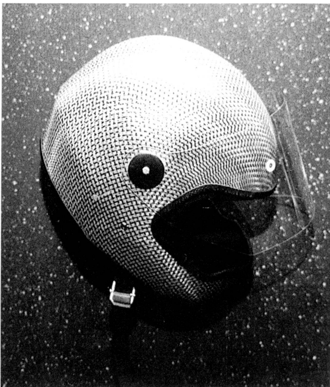
Motorradhelm aus Verbundwerkstoffen. Der Rohling zeigt deutlich die äusserste textile Schicht. Bei niedrigerem Gewicht bieten moderne Schutzhelme ungleich mehr Sicherheit und Komfort. Bild: «mittex»
