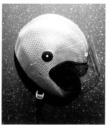
Motorradhelm aus Verbundwerkstoffen. Der Rohling zeigt deutlich die äusserste textile Schicht. Bei niedrigerem Gewicht bieten moderne Schutzhelme ungleich mehr Sicherheit und Komfort.
