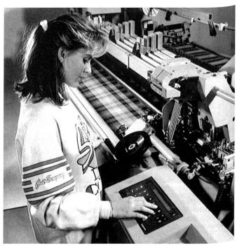
Sulzer-Rüti-Achtfarben-Greiferwebmaschine G 6100, ausgerüstet mit zentraler Mikroprozessorsteuerung
