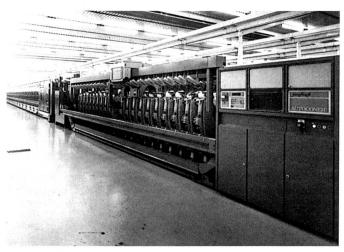
AUTOCONER® 238, hier in der Variante AUTO-spin-CONER® als Verbundsystem mit Zinser-Ringspinnmaschinen.
