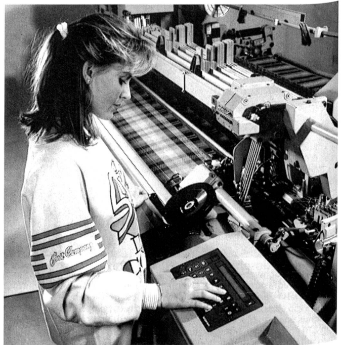
Sulzer-Rüti-Achtfarben-Greiferwebmaschine G 6100, ausgerüstet mit zentraler Mikroprozessorsteuerung
