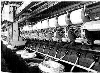
Rotor-Spinnspul-Automat AUTOCORO® 240, ausgestattet mit der neuen Spinnbox SE 9, die Rotordrehzahlen bis 130 000 Rotorumdrehungen erlauht
