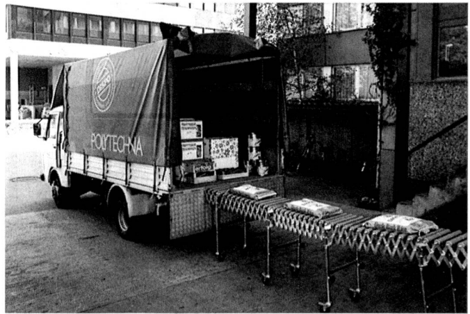
Scherenförderanlagen passen sich den Transportbedürfnissen an. Foto: Polytechna AG
