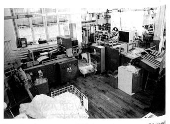
Neuer Verpackungsautomat und U-Stellung: rechts aussen am Bildrand das noch manuelle Auflegen der einzelnen Wäscheteile; anschliessend er folgen das Legen und der Aufdruck der entsprechenden Etikette, in der Bildmitte die Verpackung und links aussen das Verschweissen.
