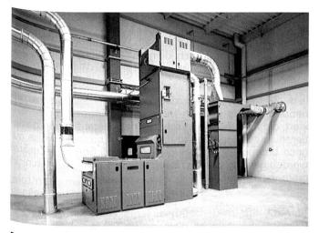
Recycling mit SEPAROMAT® ASTA Aerodynamischer Schwerteilausscheider
