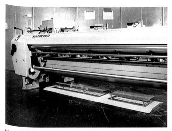
Webmaschine mit Bodenluftauslass für die Arbeitszonenklimatisierung.
