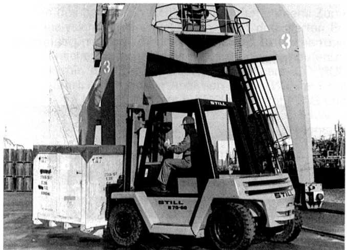
Der neue Still-Diesel-Gabelstapler R 70-60. Tragfähigkeit: 6,0 und 8,0 Tonnen.
