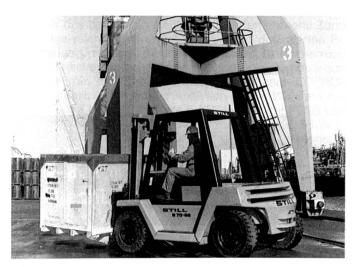
Der neue Still-Diesel-Gabelstapler R 70-60. Tragfähigkeit: 6,0 und 8,0 Tonnen.
