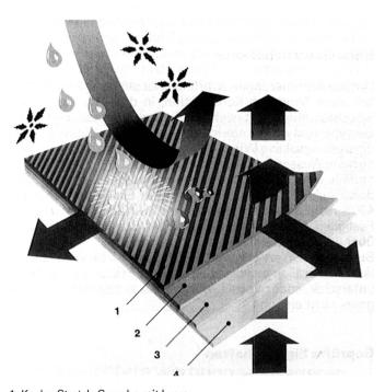
1=Kevlar-Stretch-Gewebe mit Lycra 2=hochelastische Membrane WB 400 3=Schaumstoff für exponierte Partien 4=Naturfaser – Innenseite (Frotté)
