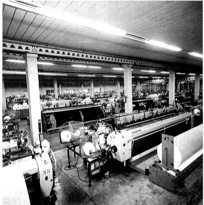
Webmaschinenanlage der Tessitura di Robecchetto Candiani S.p.A. in Robecchetto, Italien. Auf 108 Sulzer Rüti Projektilwebmaschinen mit Schussmischer stellt das Unternehmen qualitativ hochwertige Denimgewebe her.
