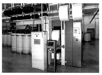
Hochleistungskämmereien setzen eine sehr gute Vorbereitung des Materials voraus. Die von Rieter entwickelte und praxiserprobte Generation von Vorbereitungsmaschinen mit der Bezeichnung UNILAP wird der hohen Anforderung voll gerecht. Das neue Verfahren führt nicht nur zu einer hervorragenden Kammqualität, sondern ist auch sehr flexibel im Einsatz.
