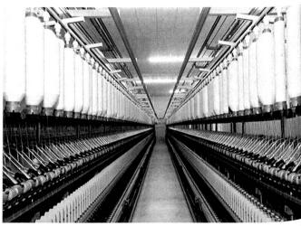
Die Ringspinnmaschine G5/2 ist eine Neukonstruktion, w<sup>0</sup> bei bewährte Konzeptionsteile, die
