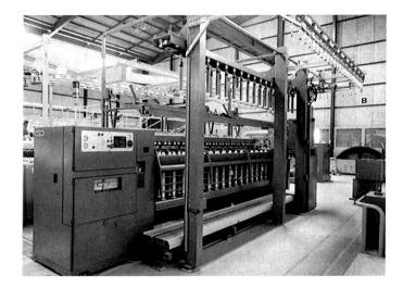
Rieter setzt seine bekannte und bewährte Flyertechnologie mit dem neuen Modell F4/1 fort. Dieser moderne, stabil gebaute und betriebssichere Flyer weist in seinem mechanischen Teil hängende, oben angetriebene Flügel, einen in der unteren Endlage schräg nach vorn ausschwenkbaren Spulentrog (Abziehhilfe) und ein präzis steuerbares Konusgetriebe auf. Ausgerüstet ist er mit dem bewährten pneumatisch belastbaren Rieter-Streckwerk.
