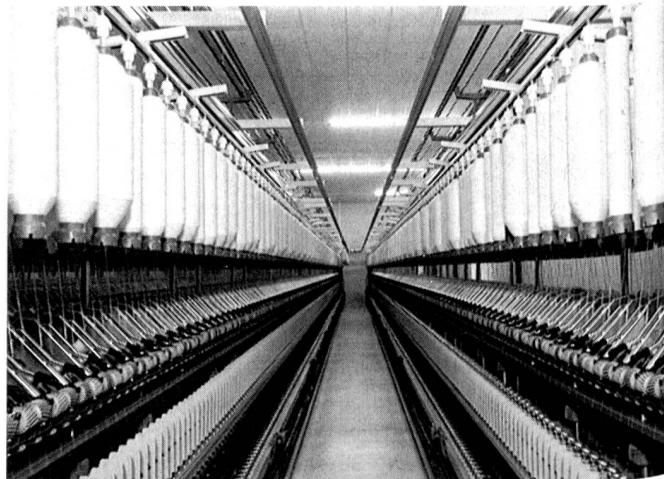
Die Ringspinnmaschine G5/2 ist eine Neukonstruktion, wo bei bewährte Konzeptionsteile, die
