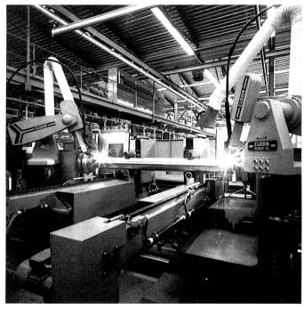
Sulzer-Rüti-Teilefamilie Walzen: Schweissanlage mit zwei Robotern zum Anschweissen der Walzenboden
