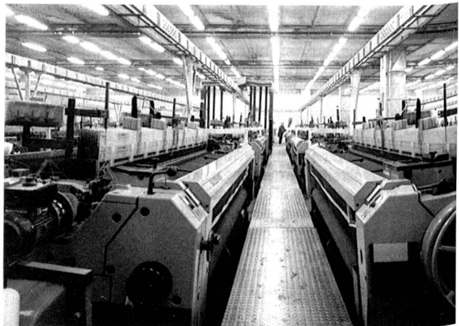
Blick in die Webmaschinenanlage der Firma Orta Anadolu in Kayseri mit Sulzer-Rüti-Projektilewebmaschinen des Typs P 7100
