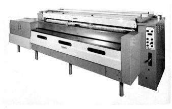
Die Trocken- und Bügelmaschine «Touraine» der französischen Firma Danube zeichnet sich durch eine hohe Leistungsfähigkeit aus; 50 bis 100 Wäschestücke, beispielsweise Tischdecken, Servietten, Laken, können mit ihr pro Stunde bearbeitet werden.
