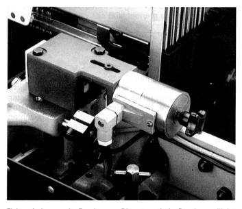
Elektronisch geregelte Fangbremse: Die automatische Regelung erübrigt ein Nachstellen der Projektilbremse und reduziert den Wartungsaufwand. Die Automatik schliesst Fehleinstellungen der Bremse praktisch aus, verringert die Beanspruchung der Projektile im Fangwerk und erhöht die Sicherheit der Fadenübergabe.
