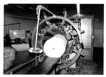
Das Transportband schiebt die Rolle durch die konische Öffnung. Das Vlies wird auf einen kleinen Teil seines Volumens zusammengepresst und direkt verpackt.
