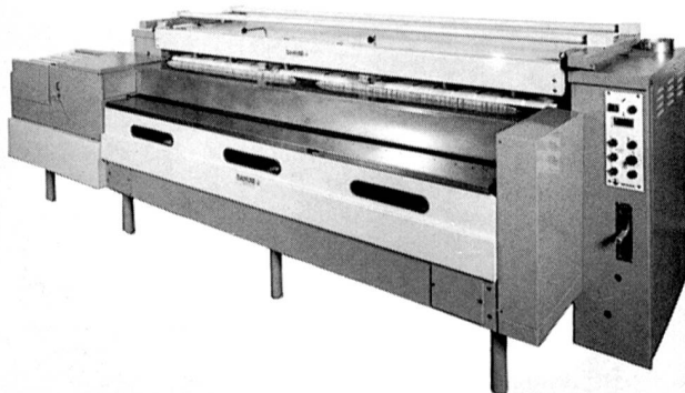
Die Trocken- und Bügelmaschine «Touraine» der französischen Firma Danube zeichnet sich durch eine hohe Leistungsfähigkeit aus; 50 bis 100 Wäschestücke, beispielsweise Tischdecken, Servietten, Laken, können mit ihr pro Stunde bearbeitet werden.
