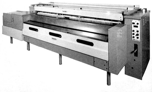
Die Trocken- und Bügelmaschine «Touraine» der französischen Firma Danube zeichnet sich durch eine hohe Leistungsfähigkeit aus; 50 bis 100 Wäschestücke, beispielsweise Tischdecken, Servietten, Laken, können mit ihr pro Stunde bearbeitet werden.
