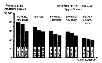
Bild 15 Theoretische Fadenauslastung beim Bremsvorgang
