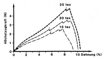
Bild 18 Kraft-Dehnungs-Diagramme (Mittelwerte) PES-/Bw-Ringgarne
