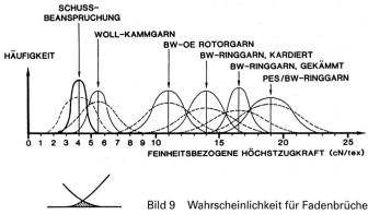
Die Folge von Fadenüberlastungen, erkennbar an der Überlappung von Belastungs- und Festigkeits-Verteilungskurve, sind bei Fasergarnen in der Regel Fadenbrüche. In Abb. 10 ist der typische Verlauf der Schussbruchhäufigkeit in Abhängigkeit der leistungsbedingten Belastungszunahme dargestellt.
