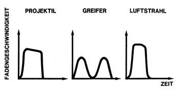
Bild 6 Geschwindigkeits-Zeit-Verlauf für Schussfadentransport (gleiche Eintragsleistung)
