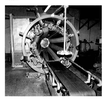
Die Verpackungsmaschine: Über ein Transportband werden die Vliesrollen in die Öffnung des Automaten transportiert. Die Vorrichtung über dem Band tastet das Volumen des Verpackungsgutes ab und meldet die Daten dem Automaten. Rund um die Öffnung sind Motoren angebracht, die wiederum Transportbänder antreiben, welche das Vlies komprimieren und zur Verpackungsstation führen.
