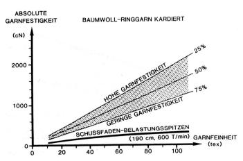
Bild 13 Vergleich der Schussfadenbelastung mit der Garnfestigkeit in Funktion der Garnfeinheit
