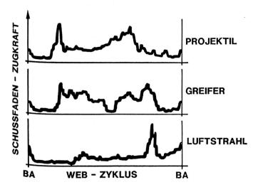
Bild 8 Charakteristischer Schussfaden-Zugkraftverlauf (gleiche Eintragsleistung)
