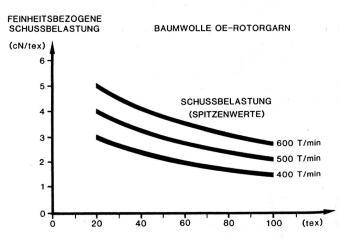
Bild 14 Vergleich der feinheitsbezogenen Schussbelastung
