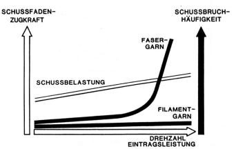
Bild 10 Fadenbruchhäufigkeit infolge leistungsabhängiger Schussfadenbelastung
