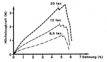
Bild 17 Kraft-Dehnungs-Diagramme (Mittelwerte) Bw-Ringgarne, gek.
