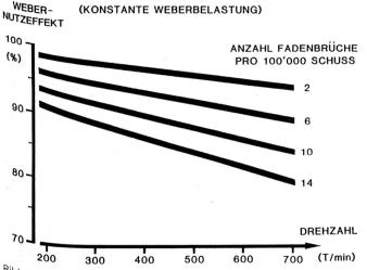
Bild 3 Webernutzeffekte als Funktion von Drehzahl und Stillstandshäufigkeit
