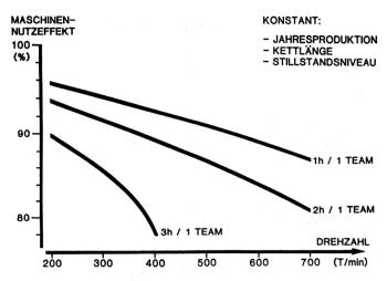
Bild 4 Maschinen-Nutzeffekt als Funktion von Drehzahl und Kettwechselzeit (Fasergarngewebe)
