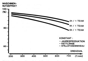
Bild 5 Maschinen-Nutzeffekt als Funktion von Drehzahl und Kettwechselzeit (Filamentgarngewebe)
