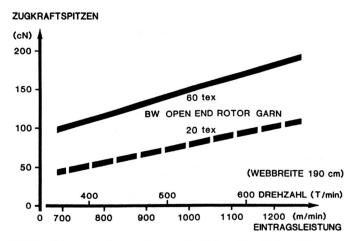
Bild 11 Schussbelastungsspitzen in Abhängigkeit der Eintragsleistung (Luftdüsen-Webmaschinen)
