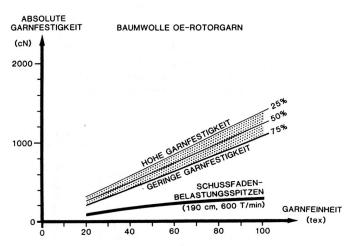
Bild 12 Vergleich der Schussfadenbelastung mit der Garnfestigkeit in Funktion der Garnfeinheit
