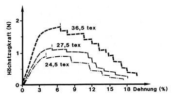
Bild 19 Kraft-Dehnungs-Diagramme (Mittelwerte) Woll-Kammgarne
