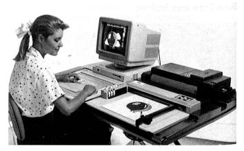
Moderne Strickereiindustrie: Ein Computerset mit Lesegerät, Farbplotter und Stanzmaschine übernimmt die Steuerung der Stickmaschinen. Alte Karten können «retour» in die Computerkartei abgelegt werden. Bild: ATI Stitchbuilders, England
