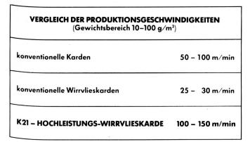
Vergleich der erzielbaren Produktionsgeschwindigkeit
