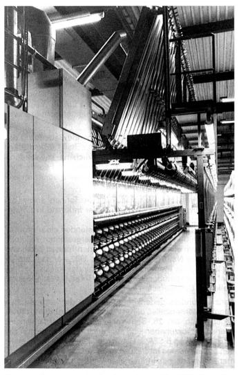
Werksfoto Barmag: Barmag-Strecktexturiermaschine FK6S-12 zur Herstellung feiner Polyamid-Strumpfgarne. Diese Maschine ist weltweit bei führenden Texturierbetrieben im Einsatz. Sie gilt als leistungsfähig und betriebssicher. Ihre technische Ausstattung ist neuester Stand der Technik.
