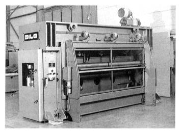
DILO-Nadelmaschine Typ DI-LOOP DS
