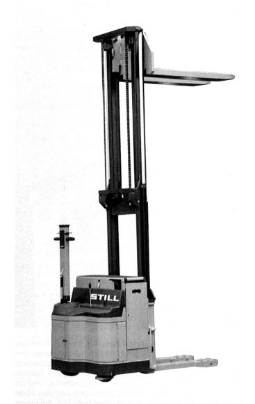
STILL-Elektro-Deichselstapler, Modell EGV Ein neuartiges Freisichthubwerk bietet dem Bediener einen umfassenden Überblick beim Einfahren in die am Boden abgestellte Palette. Der Stapler wird mit einer Tragfähigkeit für 1250 kg und 1600 kg angeboten.
