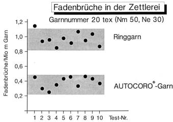
Es ist bekannt, dass die Qualität des Zettelbaumes bei jedem Fadenbruch durch die Spannungsunterschiede beim Abbremsen und Wiederanlaufen leidet.
