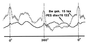
Abb. 7: Kettenspannungsverlauf von Filament- und Fasergarn
