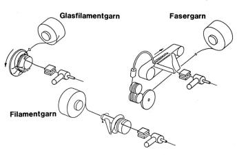
Abb. 11: Dem Einsatz angepasste Speichersysteme an Sulzer-Rüti-Luftdüsenwebmaschinen
