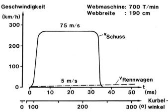
Abb. 9: Geschwindigkeits-Zeitverlauf des Schusses im Vergleich zum Formel-1-Rennwagen
