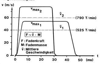
Abb. 12: Fadengeschwindigkeits-Zeitverlauf; Webbreite: 190 cm
