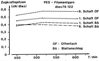
Abb.8: Kettzugkraftspitzen in Abhängigkeit der Drehzahl
