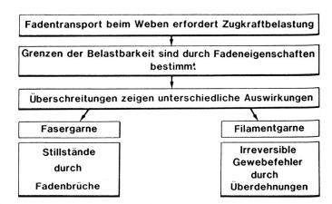
Abb. 2: Differenzierung der Überlastungsformen für Faser- und Filamentgarne
