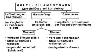
Abb. 14: Einflüsse von Filamentgarnen auf den Schusseintrag
