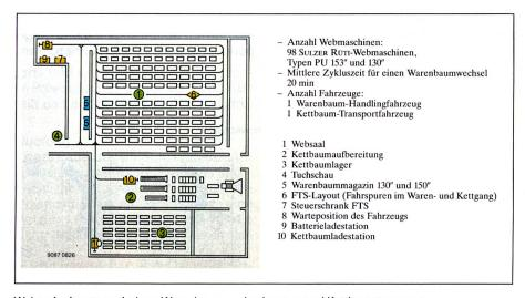
Weberei mit automatischem Warenbaumwechselsystem und Kettbaumtransport
