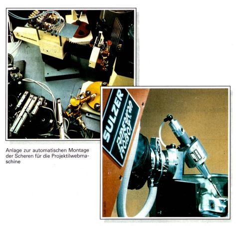
Roboter zum Entgraten der Webmaschinengehäuse
