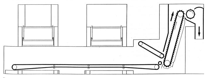
Flockenmischanlage mit Wiegespeisern und Flockenmischer FMN
