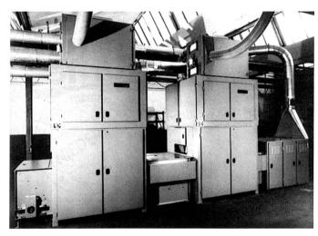
Flockenmischanlage mit Wiegespeisern PWSE, mit elektronischer Waage
