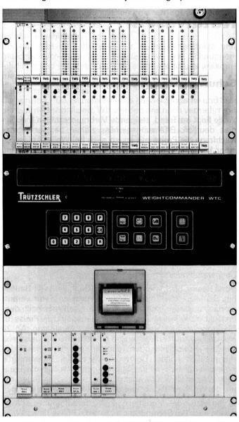
Weightcommander WTC, Mikrocomputersteuerung für Flockenmischanlagen
