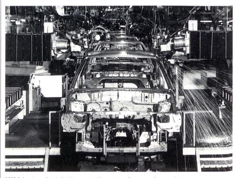
3000 Schweisspunkte sind nötig, um eine Karosserie vollautomatisch zu produzieren. Werkbild Nissan Motor Co., Werk Zama/Tokio.
