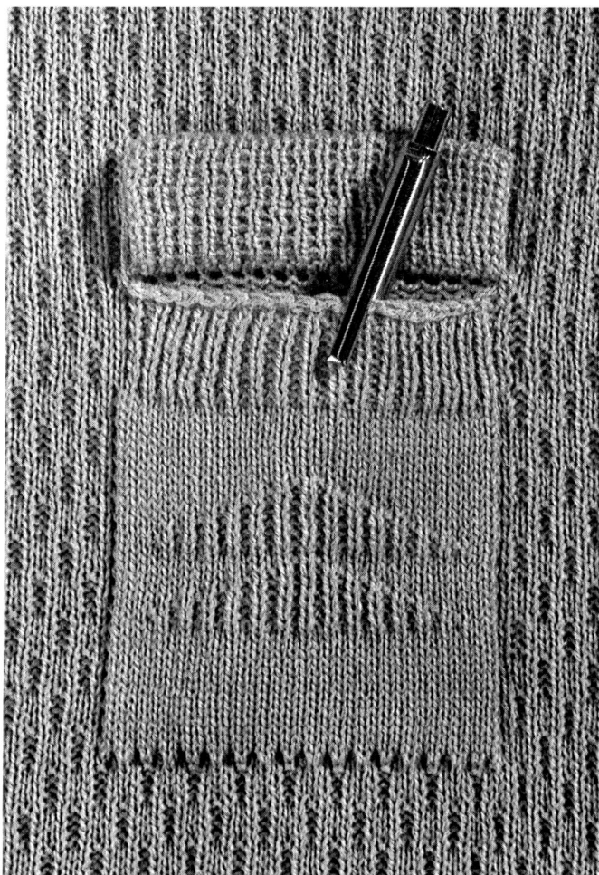
Tasche mit Patte, gearbeitet mit dem Universal- Mascheneinstreicher «Unipress».
