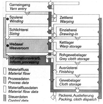
Informations- und Datenfluss online über das zentrale Leitsystem an die der Weberei vor- und nachgelagerten Produktionsstufen zur Optimierung der Garn- und Gewebequalität
