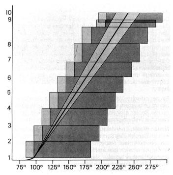
Schusseintragsdiagramm der Luftdüsenwebmaschine
