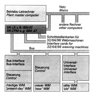
Verknüpfung Webmaschine mit Leitsystem
