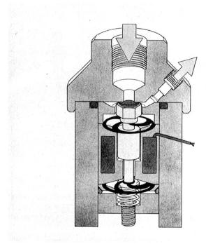
Elektromagnetisch gesteuertes Ventil
