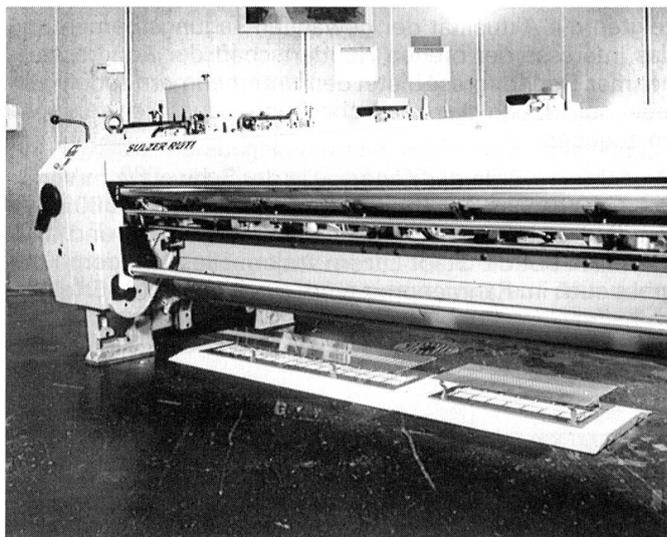
Webmaschine mit Bodenluftauslass für die Arbeitszonenklimatisierung
