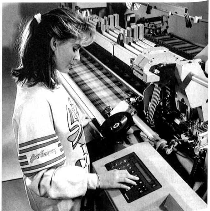
Sulzer-Rüti-Achtfarben-Greiferwebmaschine G 6100, ausgerüstet mit zentraler Mikroprozessorsteuerung
