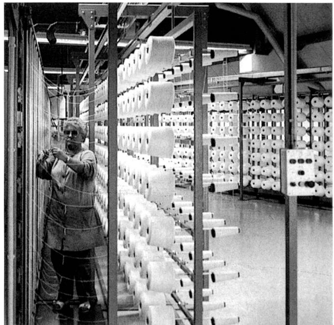
Nach dem Abfahren der Bremsengitter werden die Fäden manuell oder mittels motorisch fahrbarer Schneidwagen durchtrennt, wobei die Fadenenden in den Stopfbremsen verbleiben. Die Arbeitskraft kann sich nach dem Drehen der Rahmen mühelos zum Anknoten zwischen Spule und Faden-Stopbremse bewegen.
