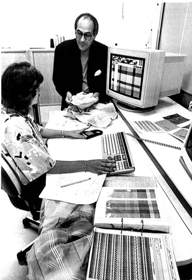
Eine neue Dienstleistung im Rohgewebegeschäft: Kreative Ideen der Kunden werden von erfahrenen Experten mittels elektronischer Unterstützung in jeder gewünschten Farb- und Dessinvariante auf den Monitor projiziert, auf Bogen ausgedruckt und schliesslich in kürzester Zeit in Gewebe umgesetzt. Dabei lassen sich nicht nur Kundenwünsche optimal berücksichtigen, auch die Vorbereitung und Steuerung des Produktionsprozesses erfolgen selbst bei komplizierten Geweben rasch und sicher.
