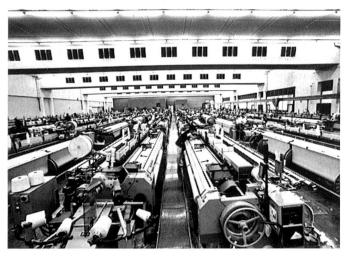
Bei der Spinnerei & Weberei Dietfurt AG sind rund 400 Webmaschinen «on-line» an eine EDV-Anlage angeschlossen, welche es ermöglicht, jede einzelne Maschine exakt zu disponieren und die Terminüberwachung fast auf die Minute genau sicherzustellen.
