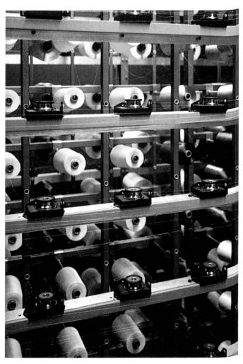
HACOBA-Schärgatter mit neuer Fadenbremse HH-FB
