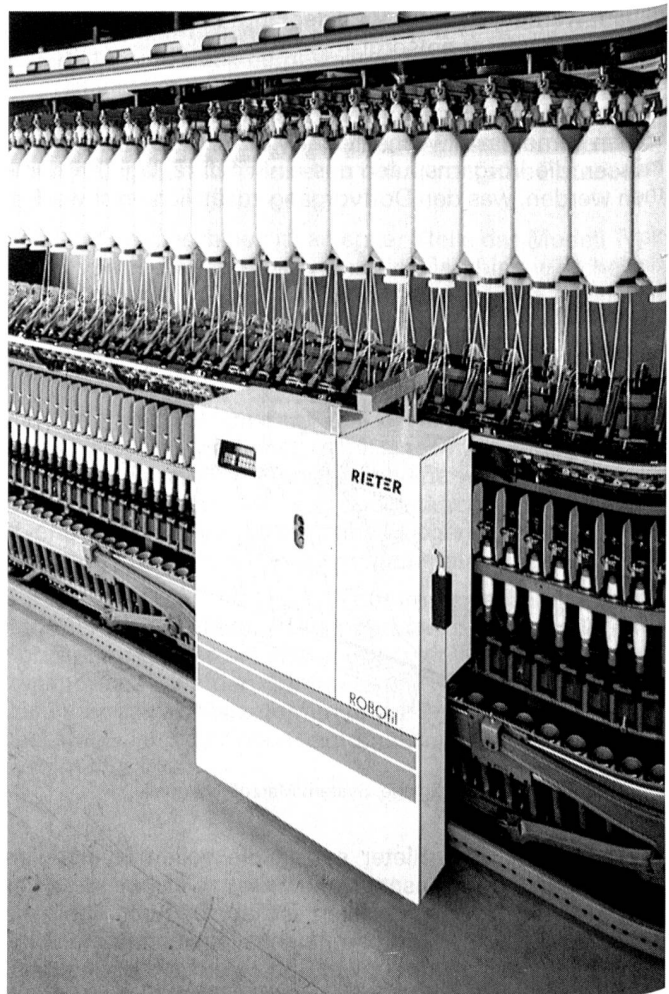
Robofil, System Rieter. CNC-gesteuerter Ansetzautomat für Ringspinnmaschinen
