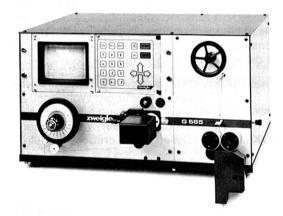
Faden-gegen-Faden- sowie die Faden-gegen-Metall-Reibung der Verarbeitungsmaschine unter praxisnahen Bedingungen. Im gleichen Prüfdurchlauf misst das G 565 die Haarigkeit nach. So ist die Möglichkeit gegeben, das Laufverhalten eines Garnes bei der späteren Verarbeitung bereits bei der Herstellung zu beeinflussen, und zwar aufgrund von exakten Messungen.
