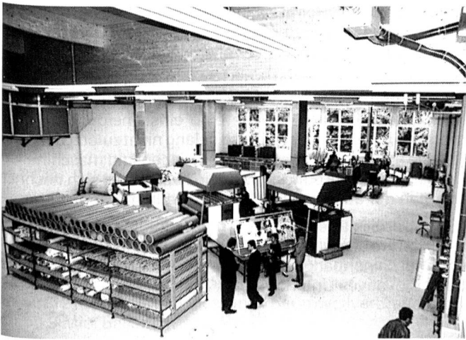
Drei Transferdruck- und zwei Spritzlaminierungsmaschinen stehen im grosszügigen Neubau zur Verfügung. (Foto mittex)
