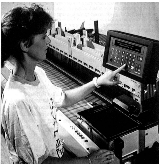
P 7100 W 190 N 4 SP D1 M Zentrale Mikroprozessorsteuerung an einer Vierfarben-Projektillwebmaschine
