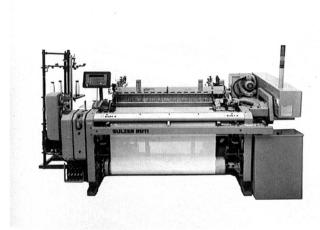
L 5100 V 140 N 1-1 IK RM Sulzer-Rüti-Luftdüsenwebmaschine mit Schussmischer mit einer Nennbreite von 140 cm, belegt mit einem Glasfasergewebe, ausgerüstet mit Zentraler Mikroprozessorsteuerung, Innentritt, Time-Controller, elektronisch gesteuertem Kettablass, automatischem Schussspulenwechsler Und Rotationsspeicher.
