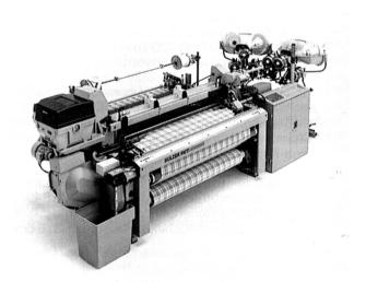
G 6100 B 190 N 8 SP Q G1 M Sulzer-Rüti-Achtfarben-Greiferwebmaschine mit einer Nennbreite von 190 cm, belegt mit einem Hemdenstoff, ausgerüstet mit zentraler Mikror prozessorsteuerung, elektronisch gesteuerter Stäubli-Schaftmaschine, elektronischer Farbsteuerung und elektronisch gesteuertem Kettablass, Kett- und Warenschaltsperre sowie Schussspeicher.
