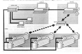
Webmaschinen-Programmier- und Archivierungssystem Sulzer Rüti PAS, kombiniert mit dem LOOMDATA-System von Zellweger-Uster.
