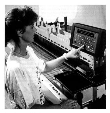
P 7100 W 190 N 4 SP D1 M Zentrale Mikroprozessorsteuerung an einer Vierfarben-Projektilwebmaschine
