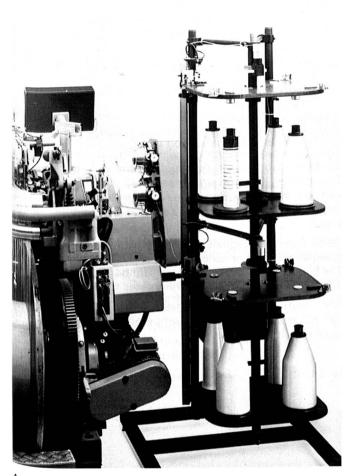
Automatischer Schussspulenwechsler an der Sulzer-Rüti-Luftdüsenwebmaschine L 5100
