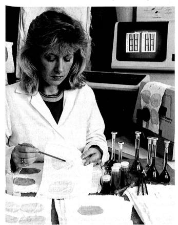
In einem in Manchester befindlichen Labor der BTTG prüft eine Technikerin Wasserfarben, um festzustellen, wie leicht sie sich aus von Schulkindern getragenen Kleidungsstücken auswaschen lassen. Diese Prüfung
