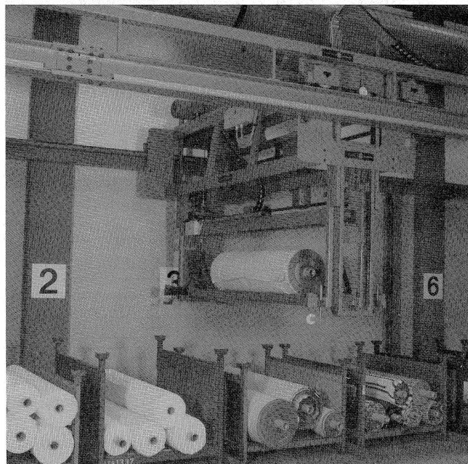
Direkt aus der Produktion übernimmt ein Transportsystem die Einzelrollen oder gebündelten Rollenlagen und legt diese in oder auf eine Palette als Kreuzstapel, Pyramidenstapel, Lagenstapel, in einer Stapelbox oder in einer Stehbox ab. (Foto Hagemann)
