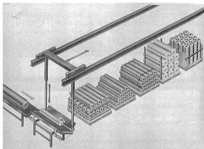
Der RoboPal R macht Einzelrollenentnahme, -transport und -palettierung möglich in Paletten bis zur maximalen Höhe von zwei Metern. Das alles geschieht sensorgesteuert. (Foto Hagemann)
