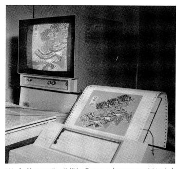
Abb. 6 Mustermotiv mit Video-Kamera aufgenommen, elektronisch an den Programmierstift gehängt und dann 3mal im Musterfeld plaziert.
