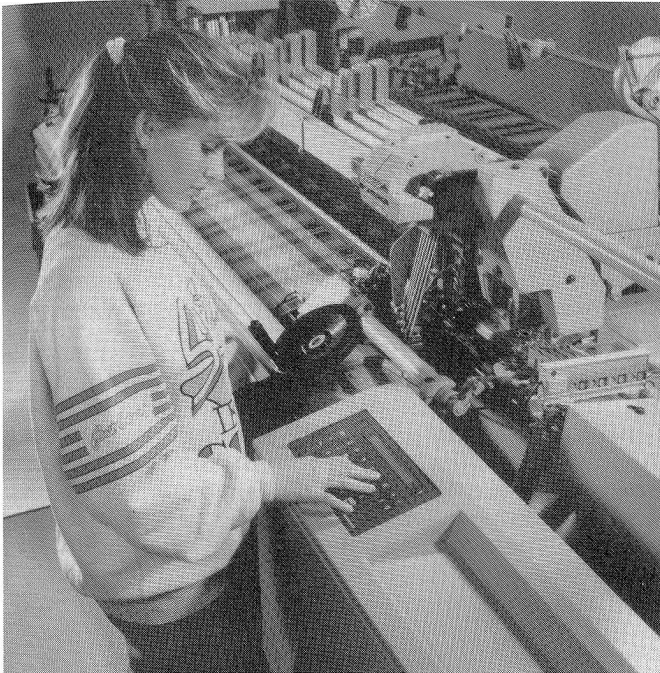
Sulzer Rütli Achtfarben-Greiferwebmaschine G 6100, ausgerüstet mit zentralem Mikroprozessor.
