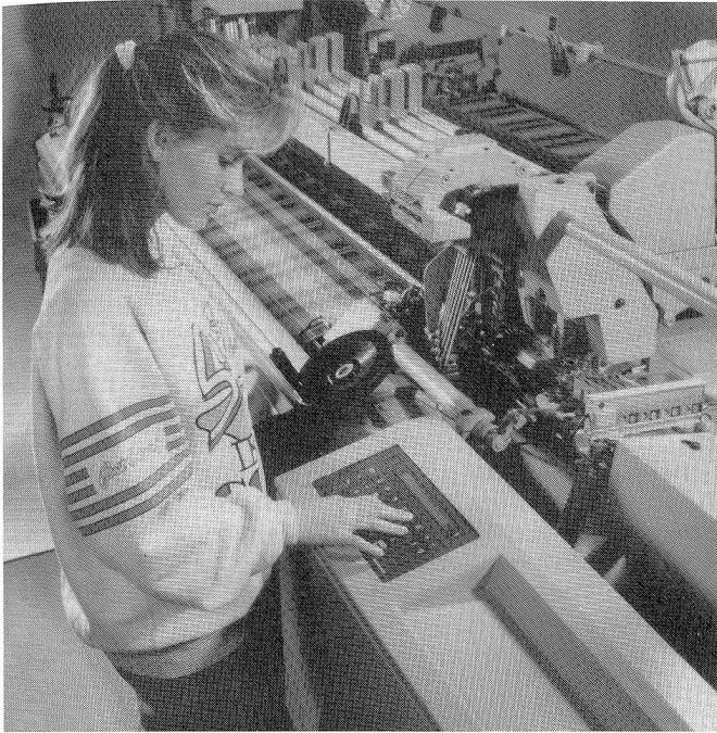
Sulzer Rütli Aachtfarben-Greiferwebmaschine G 6100, ausgerüstet mit zentralem Mikroprozessor.
