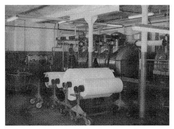
Leistungsfähige HT-Jet-Färbeanlagen der Firma Scholl
