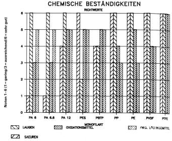
Chemische Beständigkeit (Dieses Balkendiagramm dient als Richtwertangabe. Die genauen Beständigkeiten sind von Fall zu Fall abzuklären und eventuell durch Tests zu überprüfen. Für solche Abklärungen sind folgende Angaben unerlässlich: Chemikalie – Konzentration – Einwirkungszeit – Tem-
