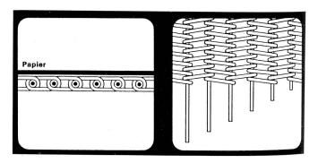
Beeindruckend ist auch die breite Palette von Monofilgeweben, die bei Monofildurchmessern von einigen tausendstel mm und Schusszahlen von über 400 Schüssen pro cm beginnt und bei Geweben mit Maschenweiten von ca. 1 cm und Drahtdicken von 1 mm aufhört.
