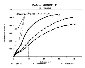
Bezugskraft: Bei der Bezugskraft handelt es sich um die Kraft bei einem vorgegebenen Dehnungswert. Üblicherweise wird mit den Werten bei 2,5 und 10% gearbeitet. Die Angabe der Bezugskräte erfolgt sowohl absolut als auch in spezifischen Werten.
