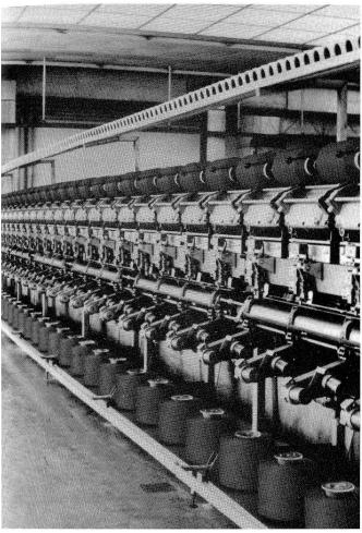
Bild 14 DIGICONE®-Spulmaschine
