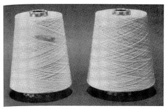
Bild 8 Spulen mit Wilder Wicklung mit Bild-(Spiegel-)zonen
