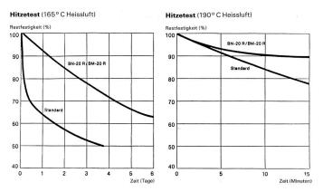
Temperaturbeständigkeit (Wie der Name sagt, gibt dieses Diagramm Hinweise auf die maximalen Gebrauchstemperaturen. Durch den Einsatz von Stabilisatorsystemen kann in einigen Fällen das Temperaturverhalten noch verbessert werden. So hat EMS zum Beispiel Grilon PA6 Monofile und Fasern entwickelt, die eine bessere Hitzebeständigkeit aufweisen. Die beiden nachfolgenden Diagramme «Hitzetest» zeigen die Verbesserung sowohl der Kurzzeit- wie auch der Langzeit-Temperaturbeständigkeit.)
