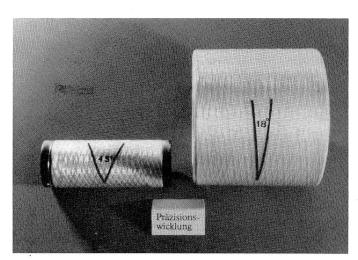
Bild 5 Spulen mit Präzisionswicklung
