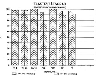
Elastizitätsgrad (Je nach Rohstoff stellt sich nach einer Zugbeanspruchung das Material mehr oder weniger stark zurück. Das Diagramm zeigt das Rückstellverhalten bei einer vorangegangenen Dehnung von 2 und 5%. Bemerkenswert ist das sehr gute elastische Verhalten der Polyamide.)
