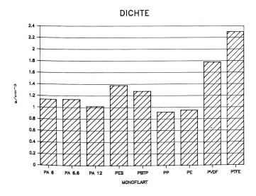
Dichte (Wie Sie aus dem Diagramm ersehen, sind PP und PE leichter als Wasser. Daher wird PP häufig für Schiffahrtsseile eingesetzt, da diese nicht versinken.)
