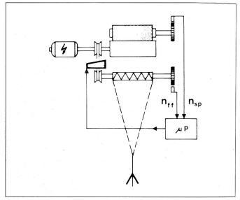
Bild 18 DIGICONE®-Regelkreis und Spulaggregatantrieb
