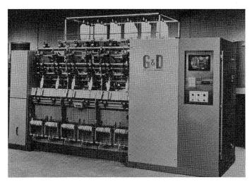
Das anlässlich der Ausstellung der International Textile Machine Association (ITMA) gezeigte Sechsspindel-Vorführmodell des Typs GDM Trite.
