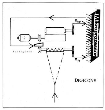
Bild 13 DIGICONE®-Wicklung mit Mikroprozessorsteuerung
