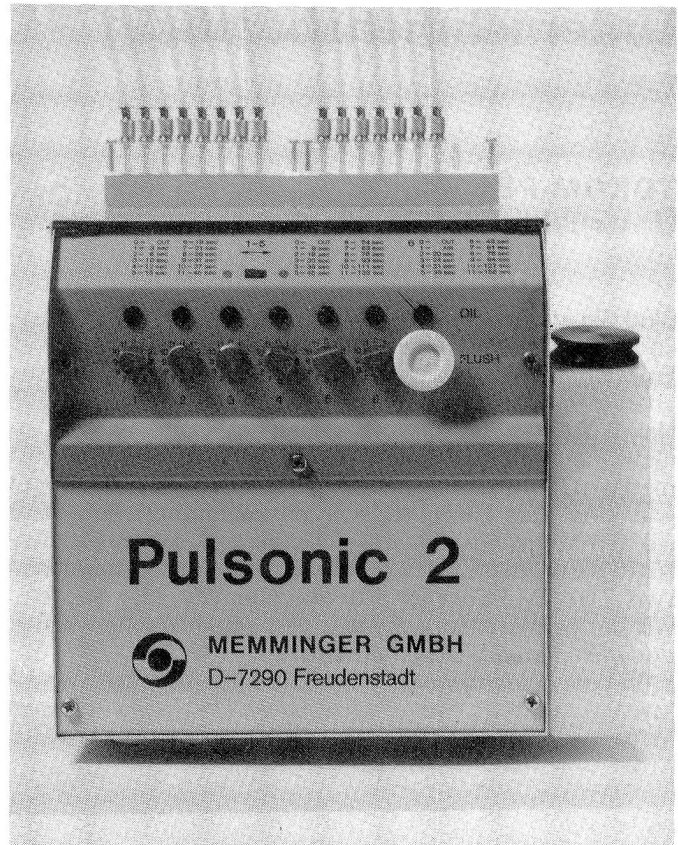
Pulsonic-2 «Maxi» für 1–15 Ölstellen mit 3,5 l Ölbehälter und elektronischer Ölflussüberwachung mit Maschinenstopp, wenn in einem der Druckschläuche kein Öl fliesst. Visuelle Ölflussüberwachung ohne Maschinenstopp auf Kundenwunsch. Bei beiden Überwachungsarten Maschinenstopp bei Erreichen des Min.-Ölstandes. Einstellbare Schmierintervalle für Gruppen von je 3 Pumpen. Sonderzubehör: Nadelzungen-schmierung mit 1 oder 2 Sprühdüsen, die für eine einwandfreie Verneblung sehr geringe Mengen Luft und Öl benötigen.
