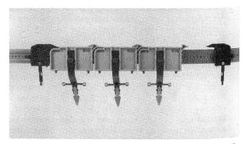
Die Abbildung zeigt den Anwendungsfall als Mehrfachkasten; drei Fødenführerkästen arbeiten auf einer Spur zusammen.
