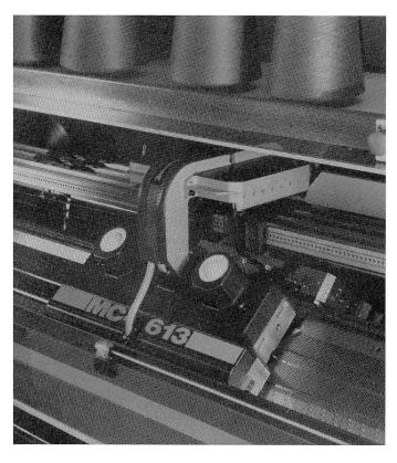
Der zweisystemige Jacquard-Umhängeautomat MC-613 überragt durch seine Produktivität und Flexibilität. Die Arbeitsbreite von 90 Zoll und eine elektronische Versatzeinrichtung sind besondere Leistungskennzeichen des Automaten.
