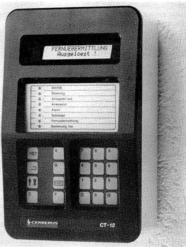
Die eigentliche Bedienung erfolgt nach Eingabe eines Passwortes über dieses ferngesteuerte kleine Gerät, das überall diskret plaziert werden kann. Der Zustand der Anlage wird dabei laufend im Klartext angezeigt.
