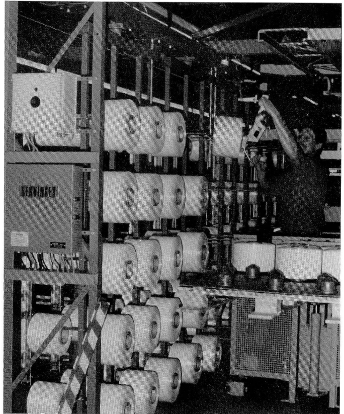
Spulenbeschickung des Gatters, Modell GS, mit Elektrokommissioniergerät ESGL und Handlingsgerät PL 25
