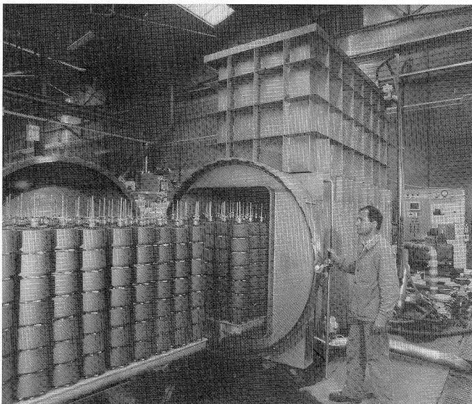
Die mikroprozessorgesteuerte Horizontalfärbemaschine Ecobox der französischen Firma Barriquand in Roanne zeichnet sich durch ihren platzsparenden Aufbau und durch die gleichbleibend hohe Qualität des reproduzierbaren Färbeergebnisses aus.
