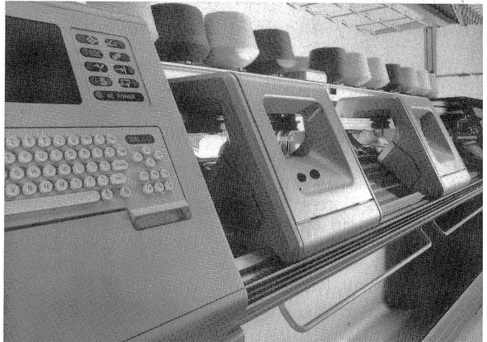
CMS 402 selectanit® Tandem Maschine, Feinheit E4–E12, Arbeitsbreite 230 cm oder 2 × 110 cm
