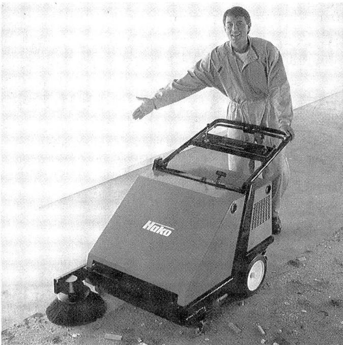
Neue Kehrsaugmaschine «Hako-Hamster 800» für die staubfreie Reinigung kleiner und mittelgrosser Flächen. Sie besitzt Fahrtrieb und einen Rückwärtsgang und ist so leise wie ein PKW.
