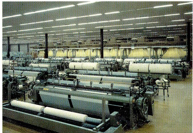
Foto 0286 0204-9 Websaal mit Sulzer-Rüti-Projektillwebmaschinen, ausgestattet mit der Condifil®-Arbeitszonenklimatisierung. Durch die Luftabsaugung im Deckenbereich kann trotz geringer Isolierung Kondensation von Luftfeuchte verhindert werden.
