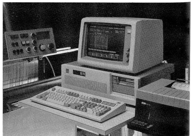
Wenn mit Hilfe eines CAD-Systems eine neue Bindung erstellt wird, so können die notwendigen Daten für den Einzug an den PC der Einziehmaschine übertragen werden.
