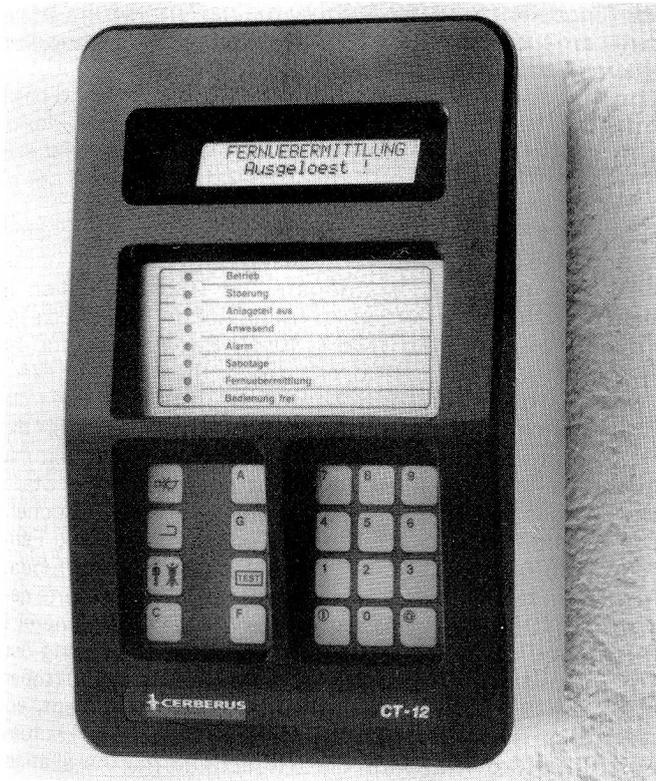
Die eigentliche Bedienung erfolgt nach Eingabe eines Passwortes über dieses ferngesteuerte kleine Gerät, das überall diskret plaziert werden kann. Der Zustand der Anlage wird dabei laufend im Klartext angezeigt.
