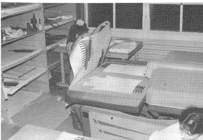
Das Thermopapier wird auf die bereits geschnittenen Bekleidungsstücke gelegt. Anschliessend werden die Teile während 40 Sekunden bei 200 ° Celsius mit 5 bar Überdruck gepresst.
