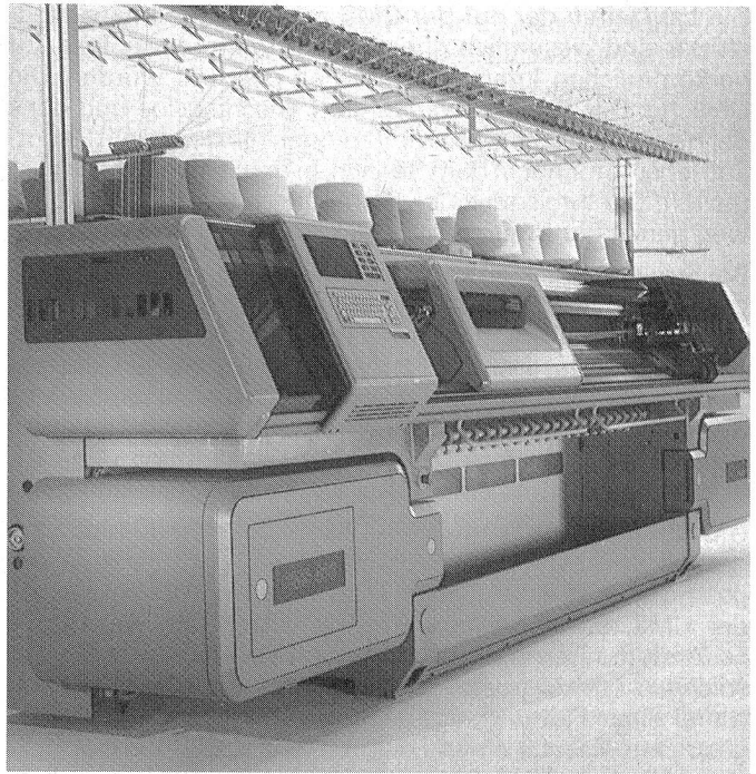
Der 4systemige CMS Selectanit Flachstrickautomat von Stoll verfügt über Software, um die neue Intarsientechnik arbeiten zu können. Es sind nur Intarsienfadenführer anstelle der Normalfadenführer aufzuschieben.
