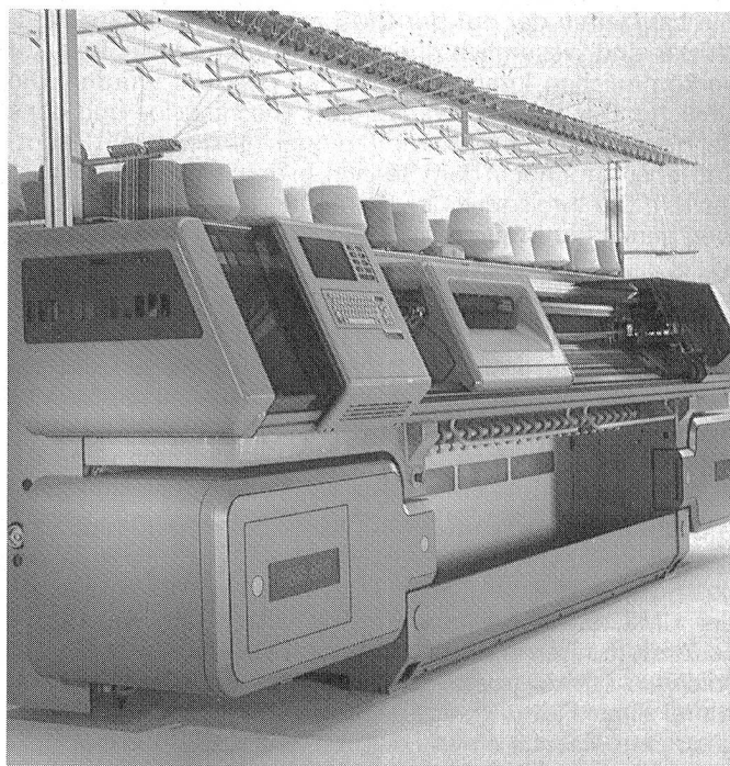
Der 4systemige CMS Selectanit Flachstrickautomat von Stoll verfügt über Software, um die neue Intarsientechnik arbeiten zu können. Es sind nur Intarsienfadenführer anstelle der Normalfadenführer aufzuschieben.
