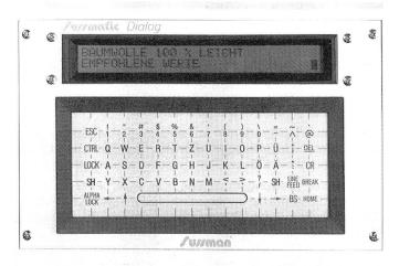
Mit der frei programmierbaren Mikroprozessor-Steuerung von Sussman können alle Funktionen des Tunnelfinishers optimal vorprogrammiert werden. Die einzelnen Finishprogramme sind dann einfach per Knopfdruck als Materialoder Artikelnummer abrufbar.
