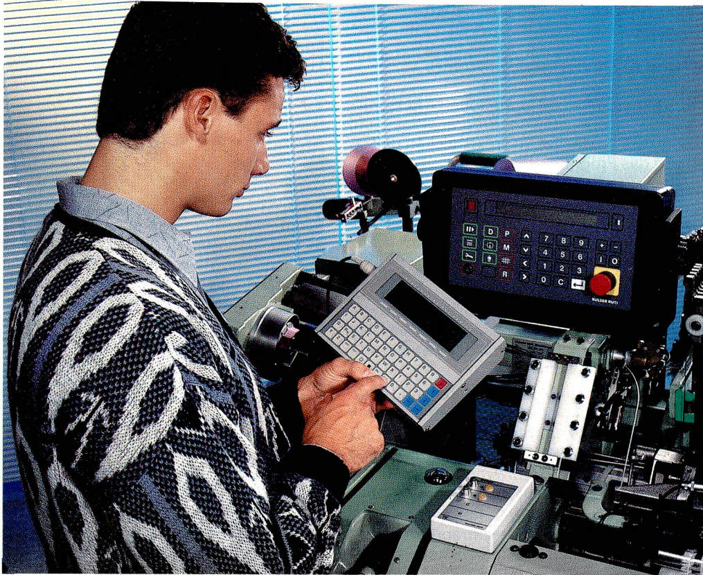
Programmier- und Archivierungssystem Sulzer Rüti PAS: On-line-Programmierung an einer Luftdüsenwebmaschine L 5100
