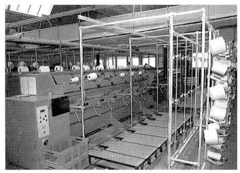
Präzisionsspul- und Fachmaschine mit 6 Spulstellen je Maschine
