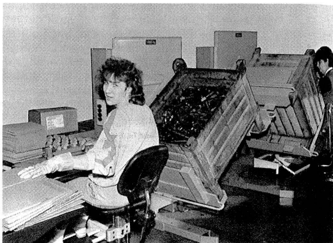
Palettenhub-Kippgeräte verhindern Rückenschmerzen durch Arbeiten auf der idealen Arbeitshöhe und reduzieren die Arbeitszeit.
